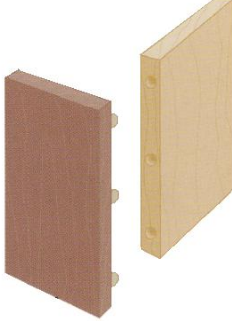
Őekil 2.38: Kavelalı en birleřtirme tekniĐi
