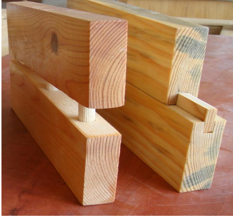
Resim 1.1: Kavelalı ve yabancı ıtalı kinişli en birleřtirmeleri
