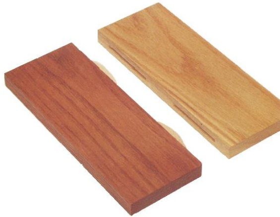
Şekil 2. 9: Zıvanalı en birleştirme tekniği
