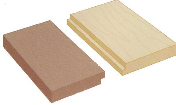
Şekil 2.4: Lambalı en birleştirme tekniği
