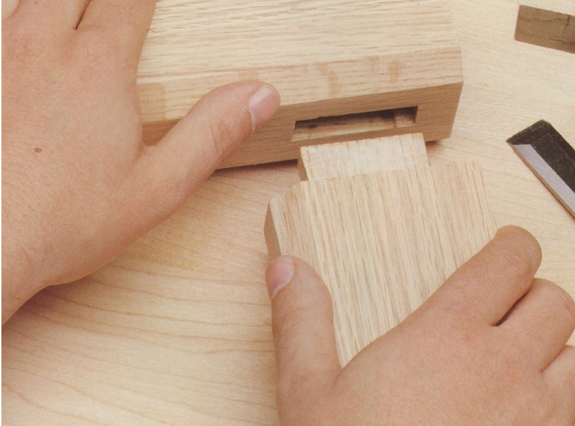
Resim 1.3: Zıvanalı ayak kayıt birleştirme
