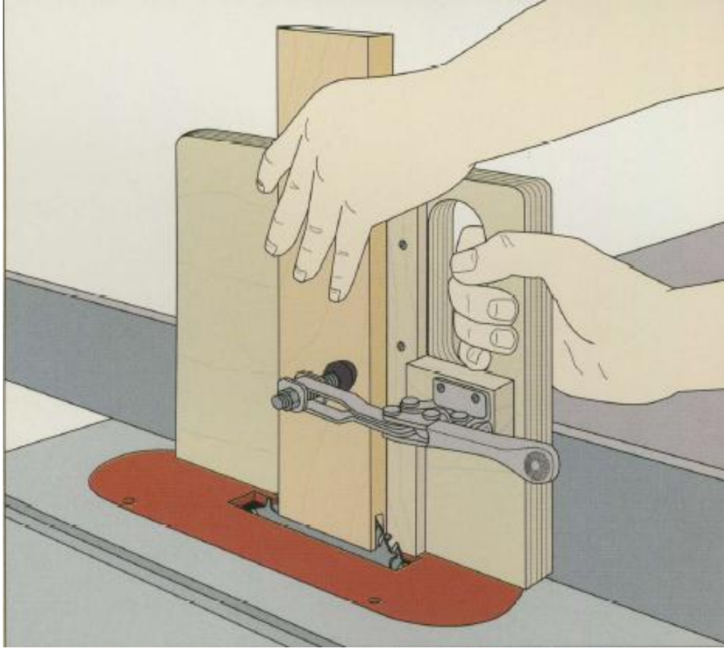
Şekil 1.13: Kınışlı paylı birleştirmede kınış açılması
