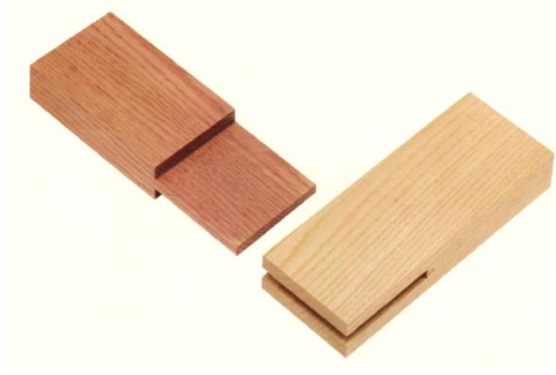
Şekil 2.14: Açık zıvanalı birleştirme tekniği
