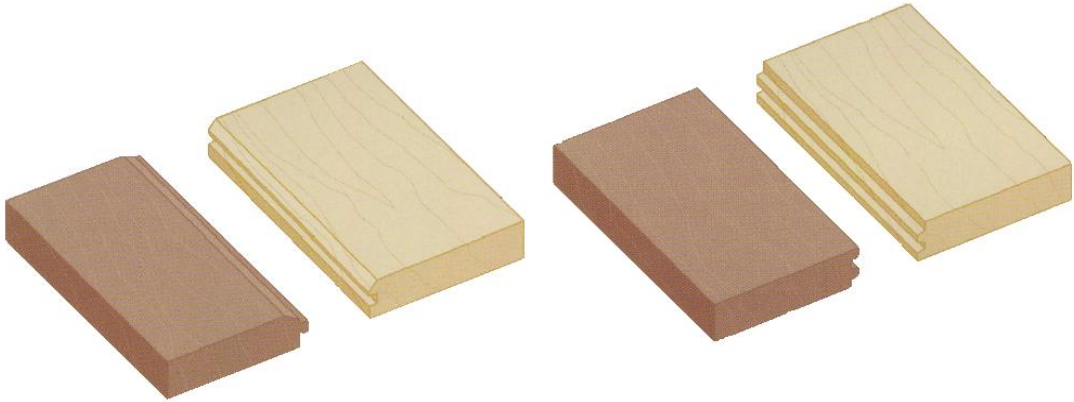
Şekil 2.11: Freze bıçaklarıyla yapılan en birleştirme teknikleri
