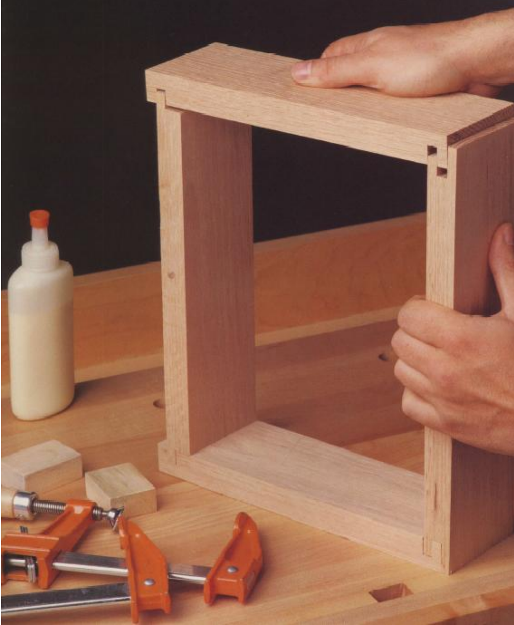
Resim 1.5: Kınışlı paylı elyaf köşeye dik birleştirme
