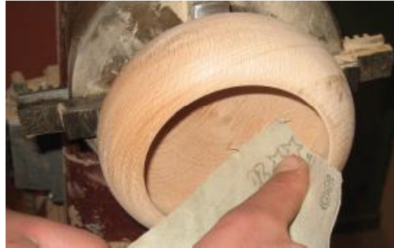
Resim 2.7: İş parçasının zımparalanması
