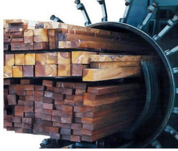
Resim 1.15: Empenye edilmek için basınçlı silindir içerisine yerleştirilerek istiflenmiş ahşap parçalar
