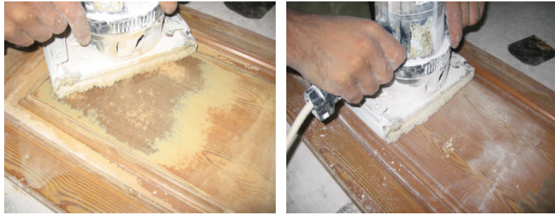
Resim 1.5: Titreşimli zımpara ile yüzeydeki boyanın temizlenmesi
