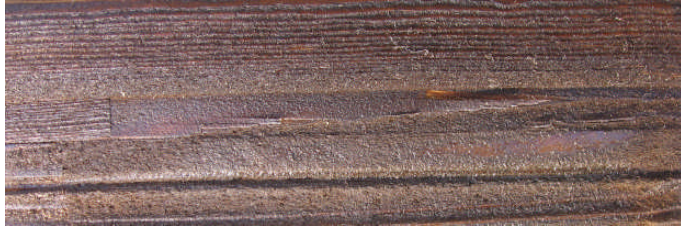
Resim 2.4: Kumlama makinesinde aşındırılmış ve Osmanlı eskitme ile renklendirilmiş ahşap söve
