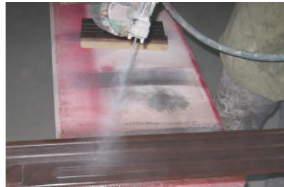
Resim 2.24: İpek mat verniğin tabanca ile uygulanışı
