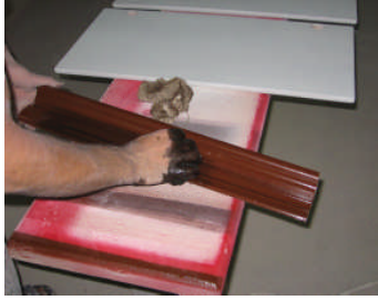
Resim 2.22: Matbaa mürekkebinin sürülmesi Resim 2.23: Ahşap görünümü sağlanmış pervaz
