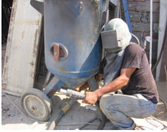
Resim 2.9: Kum ve hava basıncının ayarlanması
