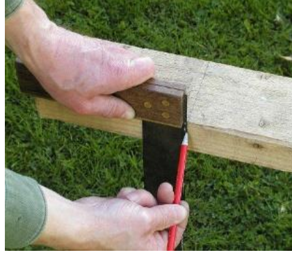
Fotoğraf 2.15. Gönye ile cumbanın markalanması
