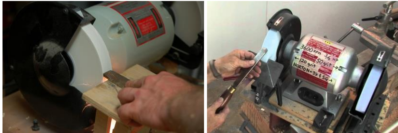
Fotoğraf 1.33. Makinede kaba bileme
