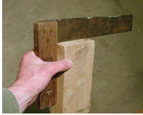
Fotoğraf 2.13. Parçanın baş kısmının kontrolü
