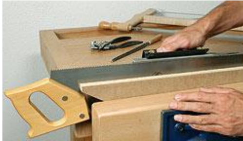
Fotoğraf 1.25. Testere uç kısımlarının eğelenmesi
