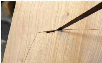
Fotoğraf 2.23. Parçanın dairesel kesimi
