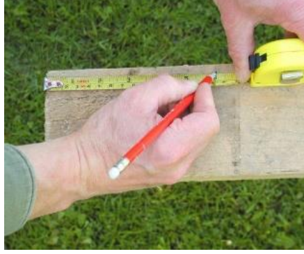
Fotoğraf 2.14. Şerit metre ile ölçü işaretleme
