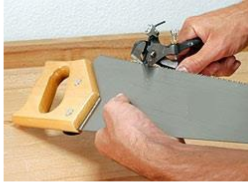
Fotoğraf 1.27. Çaprazlama yapımı
