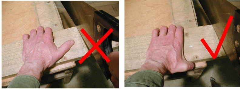
Fotoğraf 2.12. Parçanın tutulma şekli
