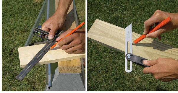
Fotoğraf 2.21. Açılı kesimde markalama
