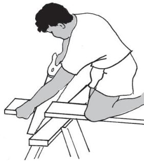
Fotoğraf 2.20. Atıl parçanın desteklenmesi
