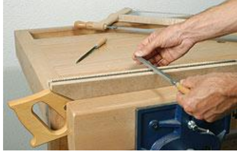
Fotoğraf 1.29. Testere dişlerinin eğelenmesi
