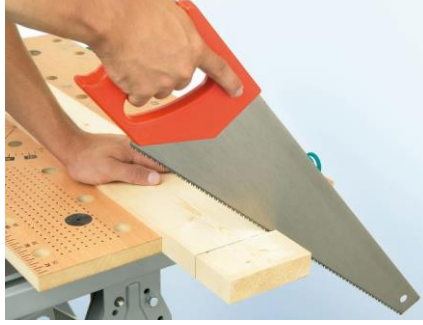
Fotoğraf 2.18. Testerenin parça ile yaptığı açı
