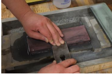
Fotoğraf 1.39. Tığ arka yüzeyinin bilenmesi
